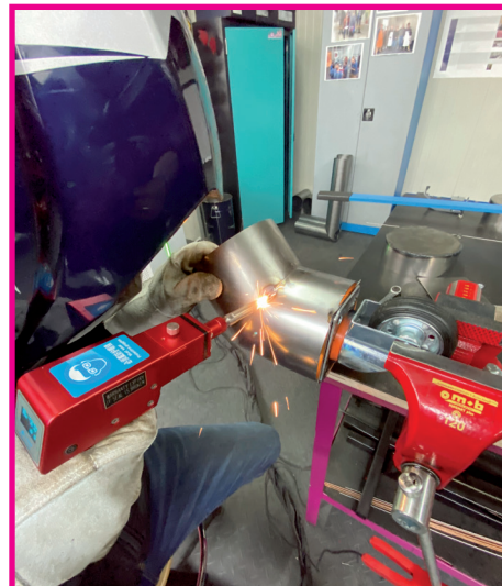
4 mm Stahl ohne Zusatzwerkstoff
